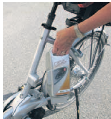
Am Flyer lässt sich die Batterie mit drei, vier Handgriffen wechseln.
